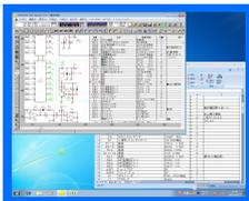
MS-Excelのファイルを開いてそのレイアウトをほぼ忠実に再現できるので、諸元表や部品表、計算を伴う表を表計算ソフトで作成し簡単に図面に取り込むことができます。レイアウトを整える必要がないので作業効率が格段に向上します。
